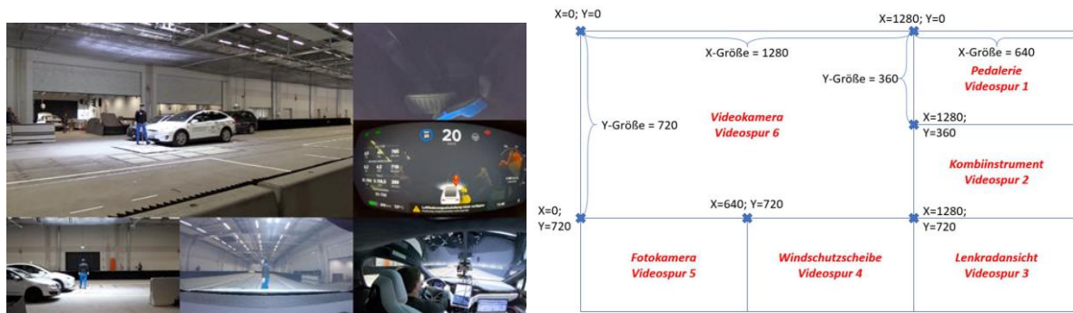
Abbildung 41: Versuchsaufbau AEB-Tests mit Kamera-Setup und Beschreibung [Quelle: Autor]
