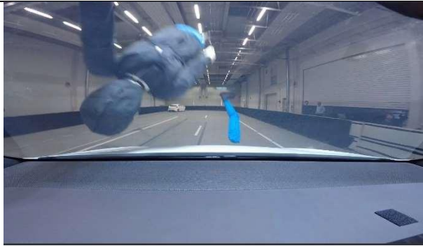
Position 5: Erkennung eines zweiten Targets an der Seite des VUT, TTC: -0,37 s
