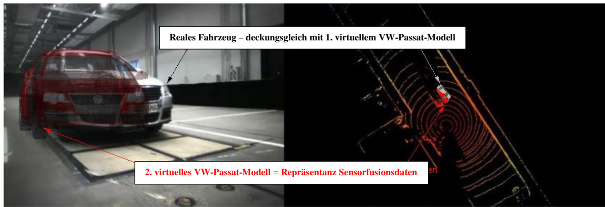
Abbildung 53: Vorläufige Ergebnisse des dynamischen Versuchsaufbaus [Quelle: Autor]
