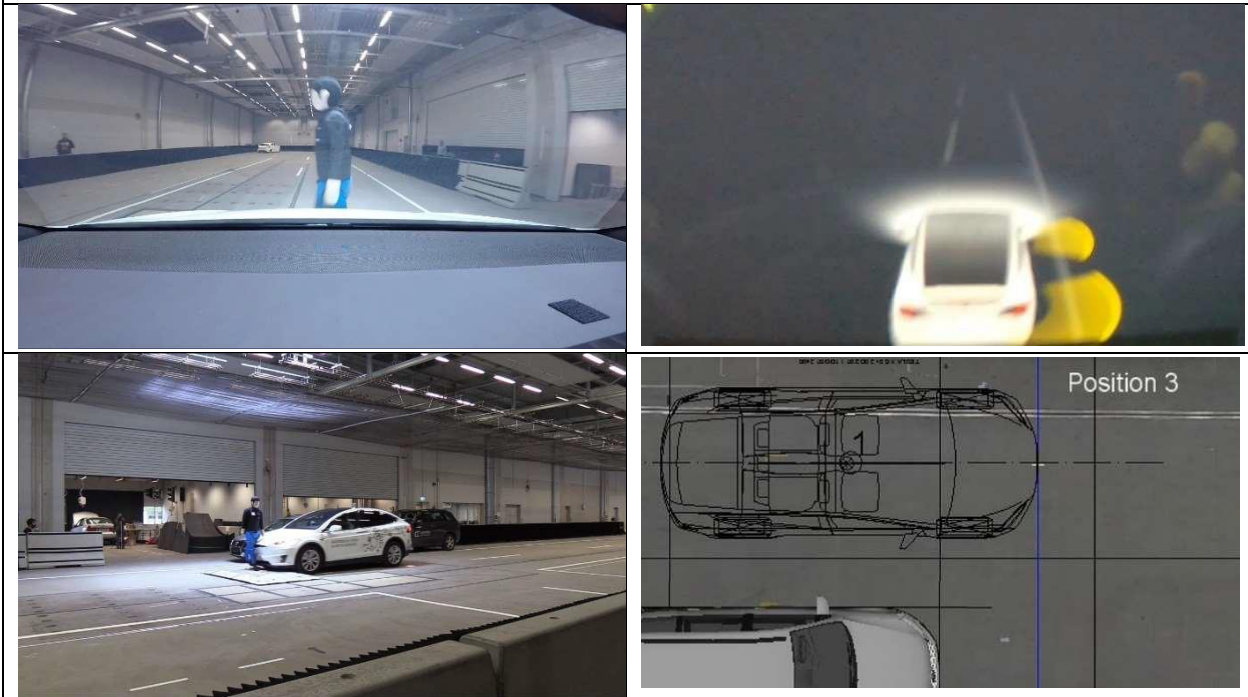
Position 3: Kollisionszeitpunkt ohne Erkennung des Targets, TTC: 0,00 s
