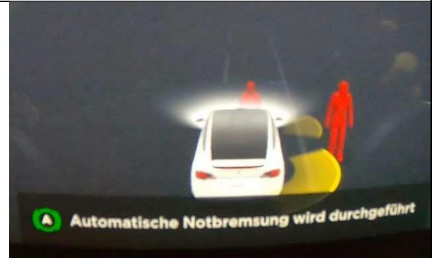
Position 5: Erkennung eines zweiten Targets an der Seite des VUT, TTC: -0,37 s
