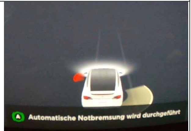
Position 6: Erkennung der am Boden liegenden Teile durch Ultraschallsensor, TTC: -1,28 s
