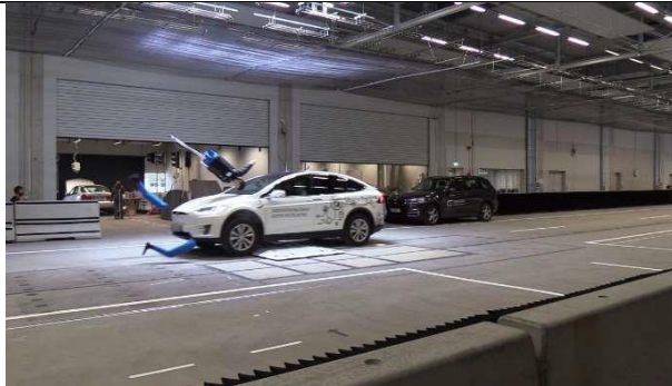
Position 6: Erkennung der am Boden liegenden Teile durch Ultraschallsensor, TTC: -1,28 s
